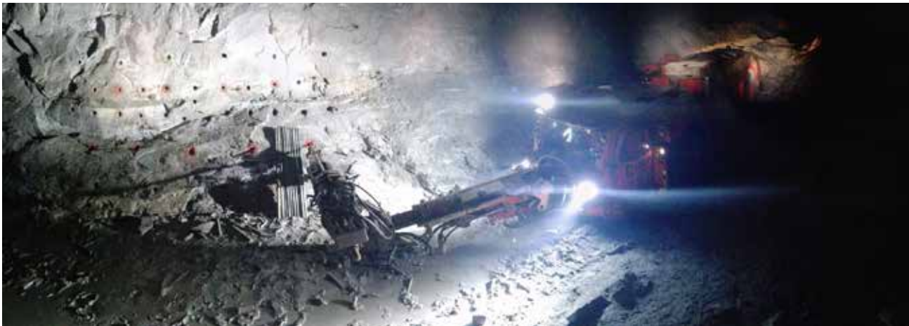
Wiercenie otworów w reaktorze.
